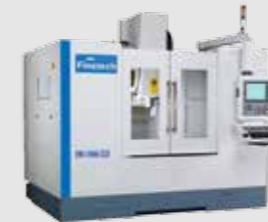
▲ 1060-2LB • Travel : X1000 Y600 Z560 mm • Table : L1100×W500 mm
