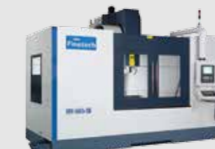
▲ 1685-3B/1690-3B • Travel : X1600 Y900 Z900 mm • Table : L1800×W840 mm
