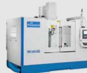
▲ 1485-H3L • Travel : X1400 Y850 Z850 mm • Table : L1500×W800 mm
