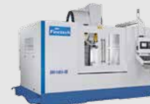
▲ 1485-3B • Travel : X1400 Y850 Z850 mm • Table : L1500×W800 mm
